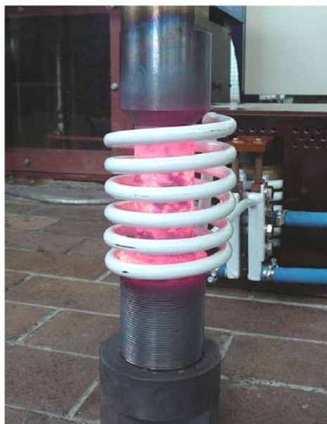
Obr. 1: Zařízení pro materiálově-technologické modelování vzorků s velkým objemem
